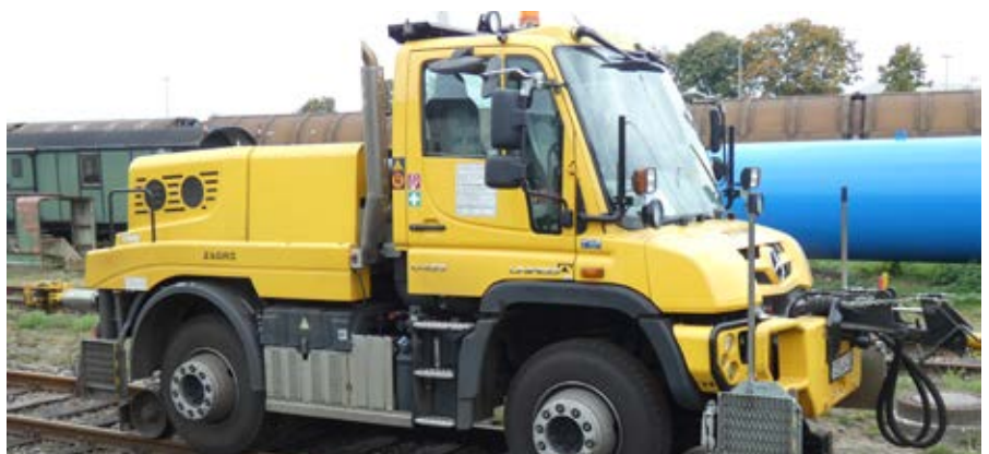
Ungewöhnliches Zweibegefahrzeug Ein Mercedes-Unimog für Schiene und Straße
