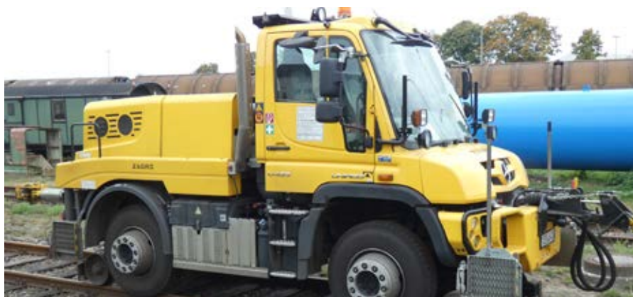
Ungewöhnliches Zweibegefahrzeug Ein Mercedes-Unimog für Schiene und Straße
